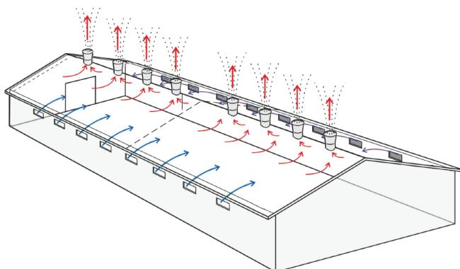
КП-AGR используются в системах вентиляции с отрицательным давлением
