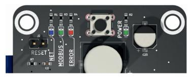
На плате устройства установлено четыре светодиода, которые отображают текущие статусы работы системы. Каждый светодиод имеет свое назначение и помогает оперативно диагностировать состояние устройства.
