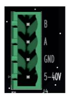
Клеммы А и В - подключение сигнальных проводов передачи данных по интерфейсу RS-485. Положительный (A) и отрицательный (B) сигнальный провод подключаются к клеммам контроллера, которые обозначены как:
