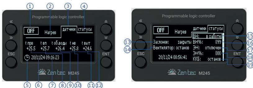
3.2 На главном экране с помощью клавиш «перемещение влево» или «перемещение вправо» будет происходить переход из раздела «датчики» в раздел «статусы», где можно отслеживать производительность узлов регулирования и статус устройств.
