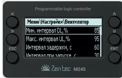
В автоматике реализована функция снижения производительности вентилятора в случае, если не хватает производительности нагревательного элемента. Эта функция помогает поддерживать температуру поступающего воздуха на уровне уставки.
